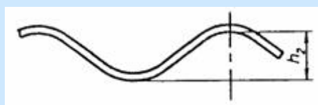
Рисунок 1-Форма поперечного сечения волнистого листа
