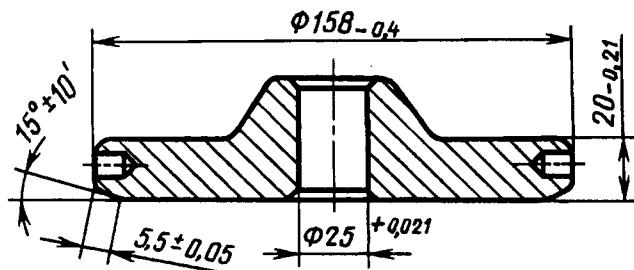
2.3. Диски диаметром 178 мм. Диски диаметром 225 мм перед испытанием обрезают до диаметра 178 мм.
